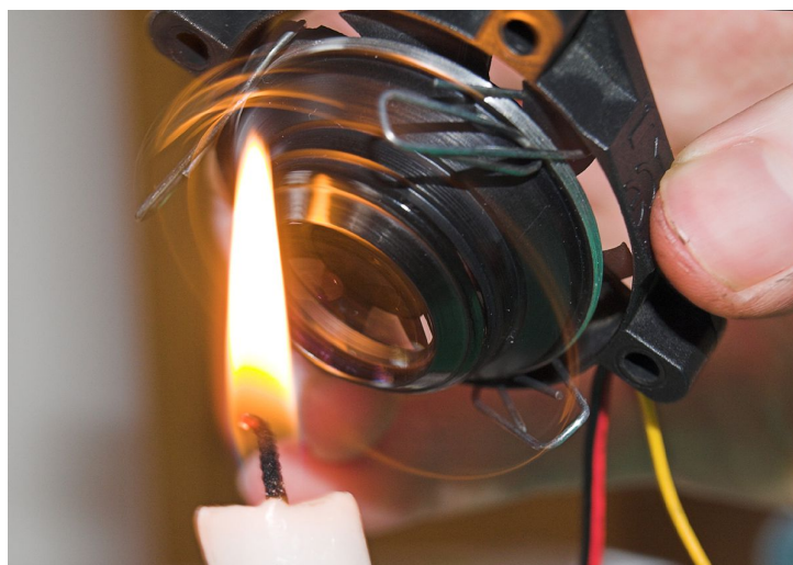
Abbildung 3.8: Beschichtung der vorderen Objektivbaugruppe mit Ruß
