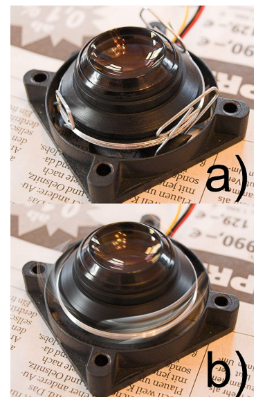
Abbildung 3.7: Montage der Objektivbaugruppe auf PC-Lüfter
