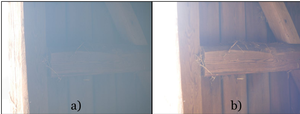
Abbildung 6.1: Testbild zur Feststellung der Streulichtempfindlichkeit, a) 50 mm F2.4 [T3.4] V1, b) Pentacon 50 mm F1.8 bei Blende 1.8 (Aufnahmen jeweils ohne Sonnenblende)
