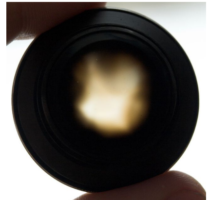
Abbildung 3.5: Transmission durch vordere Objektivbaugruppe nach Beschichtung mit Ruß
